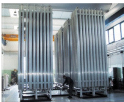
Figura 12- Vaporizador atmosférico de gás [7]
